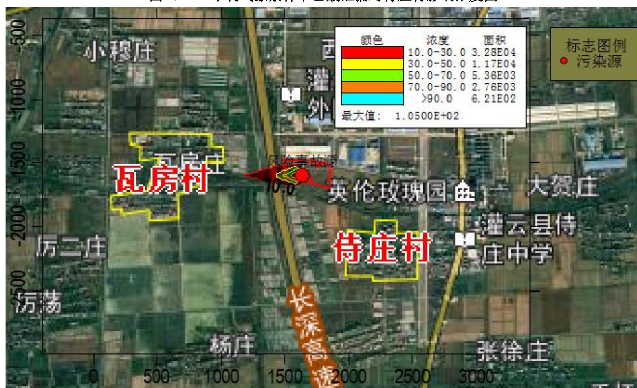
图 7.1-2 不利气象条件下乙酸泄漏对瓦房村影响浓度图
