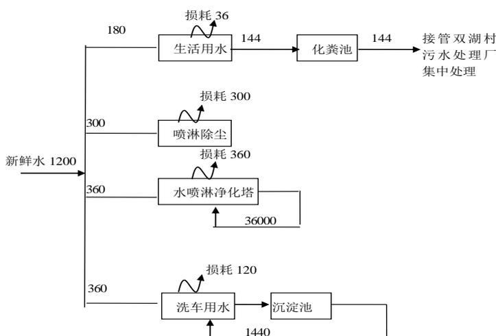
图 4-1 项目水平衡图 (t/a)
