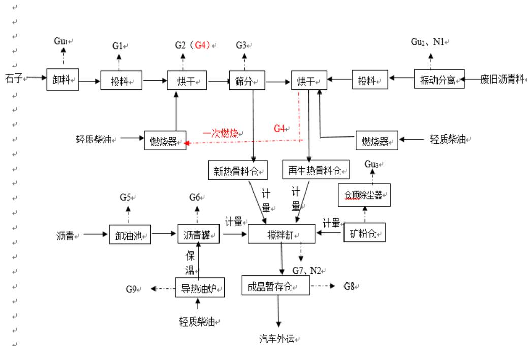
图 2-2 沥青混凝土生产工艺流程图
