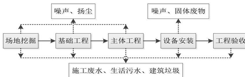
图 2-1 施工期工艺流程及产污环节图
