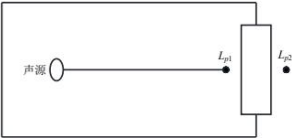
图 4-2 室内声源等效为室外声源图例
