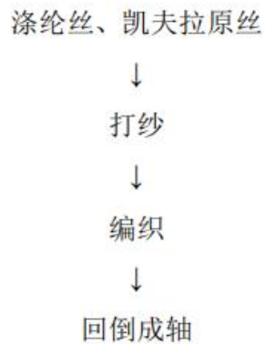
图 2-3 编织线生产工艺流程图
