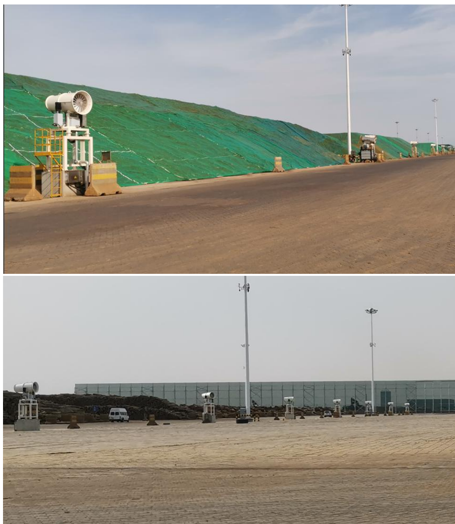
图 5.2-15 堆场设置的高压射雾器照片
