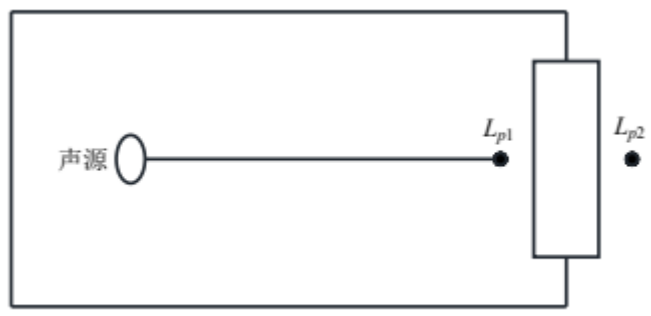
图 4-3 室内声源等效为室外声源图例
