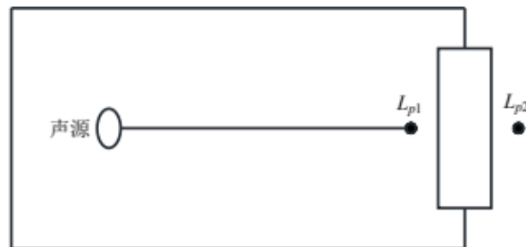
图 4.3-1 室内声源等效为室外声源图例
