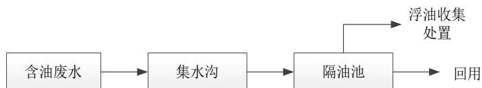
图 5-2 含油废水处理工艺
