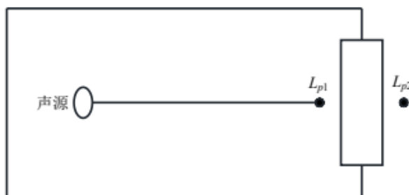
图 4-2 室内声源等效为室外声源图例
