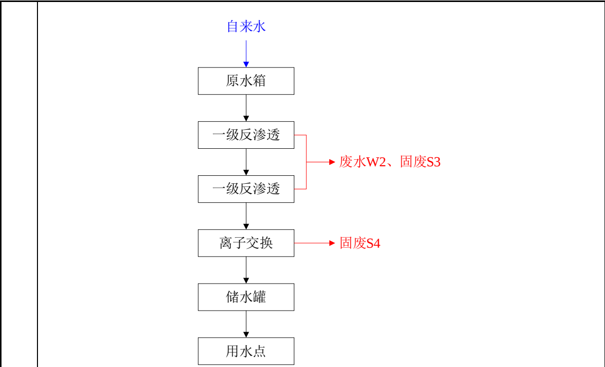
图2-3 纯水制备生产工艺流程及产污环节图
