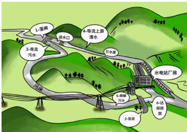
图 1 引水式电站与临时筑坝蓄污在应急处置中的使用步骤
