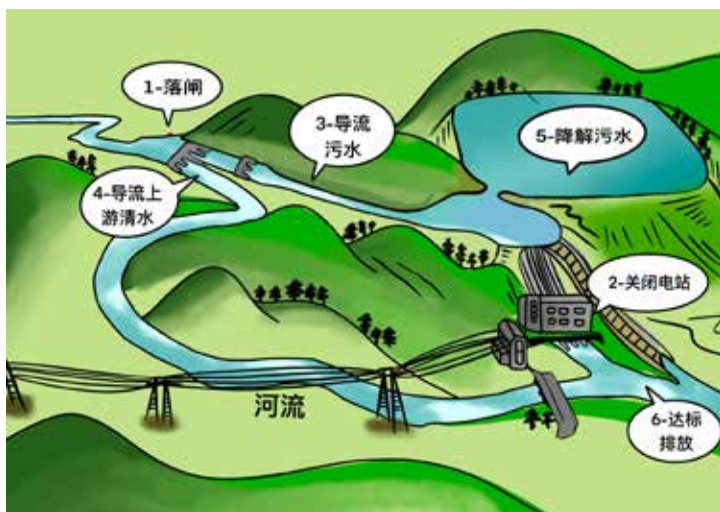
图2 引水式电站与导水渠在应急处置中的使用步骤
