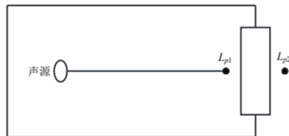
图 4.3-1 室内声源等效为室外声源图例
